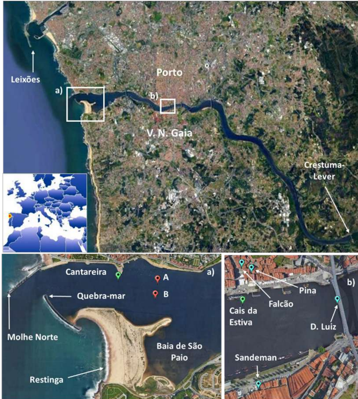
Figura 1. Principais estruturas do estuário do rio Douro e pontos de amostragem: a verde locais de medição da elevação da superfície livre, a vermelho locais de medição das correntes e a azul os locais com marcas de níveis atingidos durante cheias históricas consideradas. (Fonte: Google Earth).
